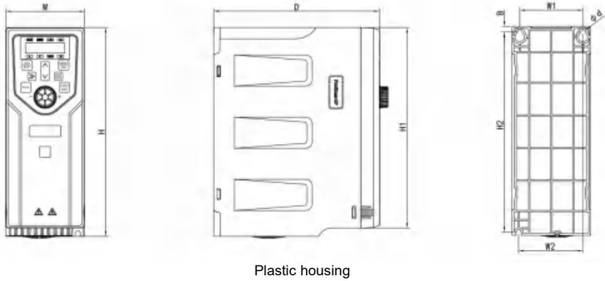
Fig. 2.4-1 Overall dimensions of FG310-2S、2T(0.75kW~2.2kW)、 FG310-4T(0.75kW~4.0kW)
